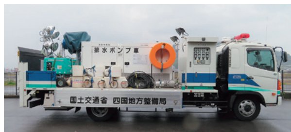
排水ポンプ車（国土交通省所有）
