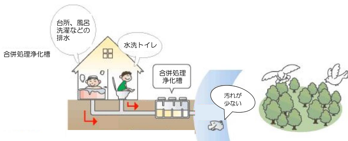
図 3-2 合併処理浄化槽のしくみ
