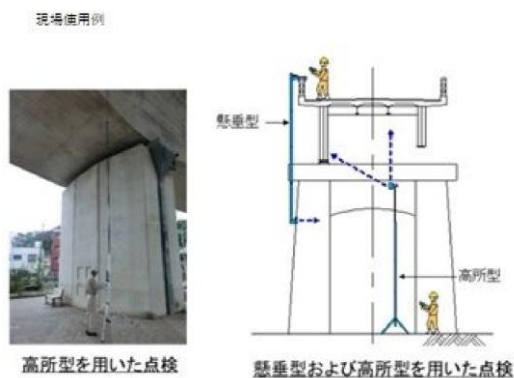
図 6 新技術活用事例（ロボットカメラ）
