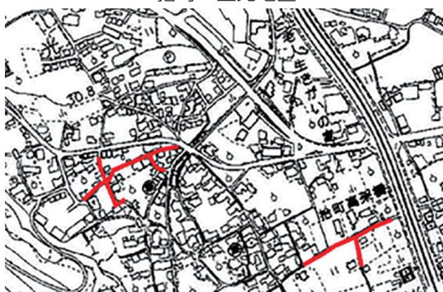
**工事内容** 道路を掘って直径15cmから20cmの下水道管を布設します。
