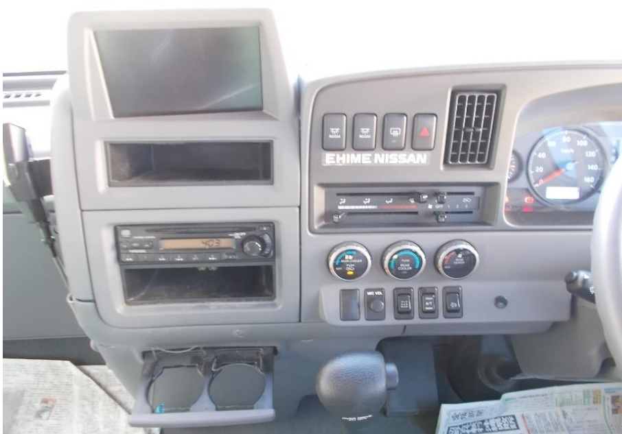
園児送迎バス ニッサンシビリアン インテリアパネル エアコンスイッチ バックモニター他
